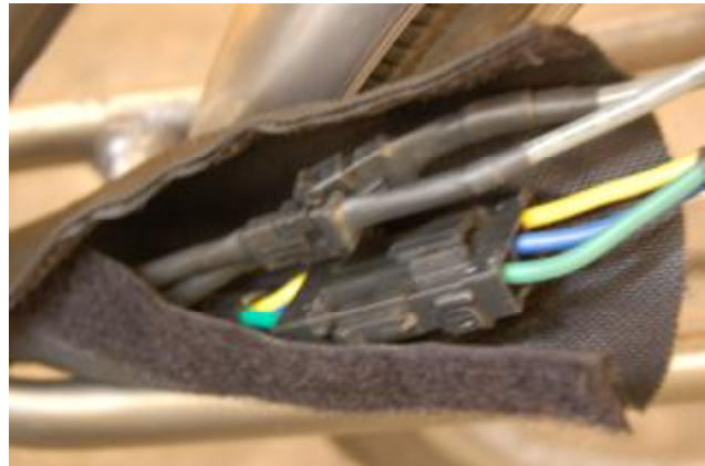
(10A) Optional Wire Wrap, Enclosing Connectors
